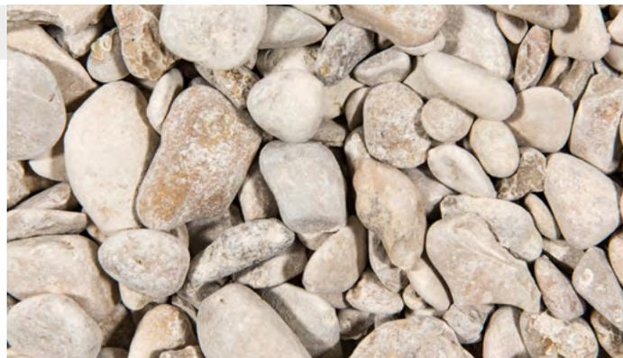
livré 120 tonnes de granulats issus de la carrière sur notre plateforme d'Épernay, d'où elles ont été resoufflées sur la toiture-terrasse de Moët & Chandon. » Matériau drainant parfaitement adapté à cet usage, le 8/20 NF roulé lavé de Matignicourt a également séduit par sa couleur lumineuse. Moët & Chandon en a d'ailleurs commandé 40 tonnes supplémentaires afin de rénover dans la foulée la toiture de son laboratoire. ●
